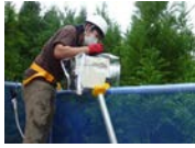
森林タワーにおけるポータブルゲルマニウム検出器を用いた放射能測定
